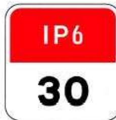
03b - Demarcação miriámetrica da via - IP
