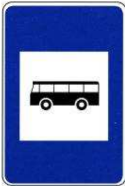
H20a – Paragem de veículos de transporte colectivo de passageiros
