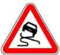
A5 – Pavimento escorregadio
