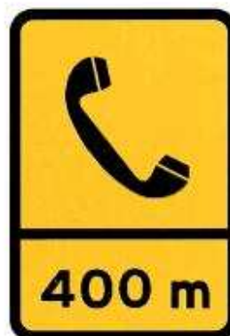
ST12 – Telefone de emergência
