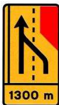
ST2 – Supressão de via de trânsito
