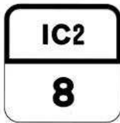
02c - Demarcação quilométrica da via - IC
