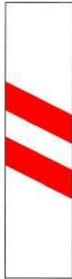
19e – Aproximação de passagem de nível
