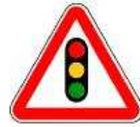
A22 – Sinalização luminosa
