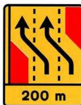
ST4 – Desvio de via de trânsito
