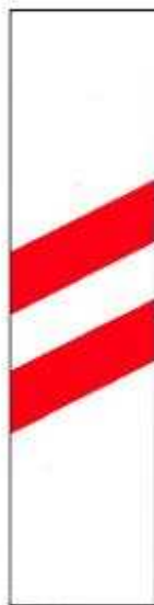
19b - Aproximação de passagem de nível
