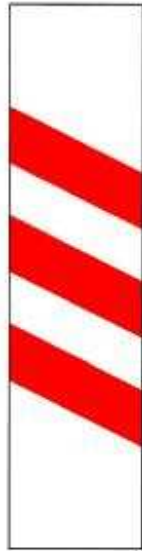
19d – Aproximação de passagem de nível
