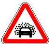
A13 - Visibilidade insuficiente
